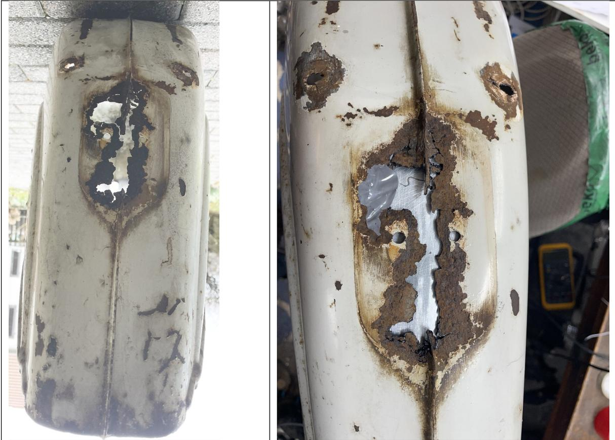
Am Rücklicht hatte sich über Jahre Wasser angesammelt und unter der Farbe war nur noch Rost. Das habe ich mit Blech und Chemical Metal wieder stabilisiert. Auch an der Lampe musste geklebt werden
