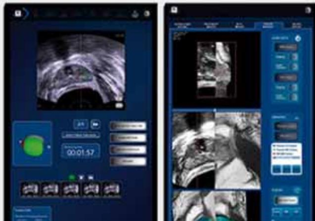
7. Beim Focal One können MRT- oder 3D-Biopsiebilder eingelesen werden, die dann mit dem 3D-Ultraschallbild des Geräts verschmolzen (elastisch fusioniert) werden. Auf dieser Grundlage plant der Arzt die Behandlung am Bildschirm.
