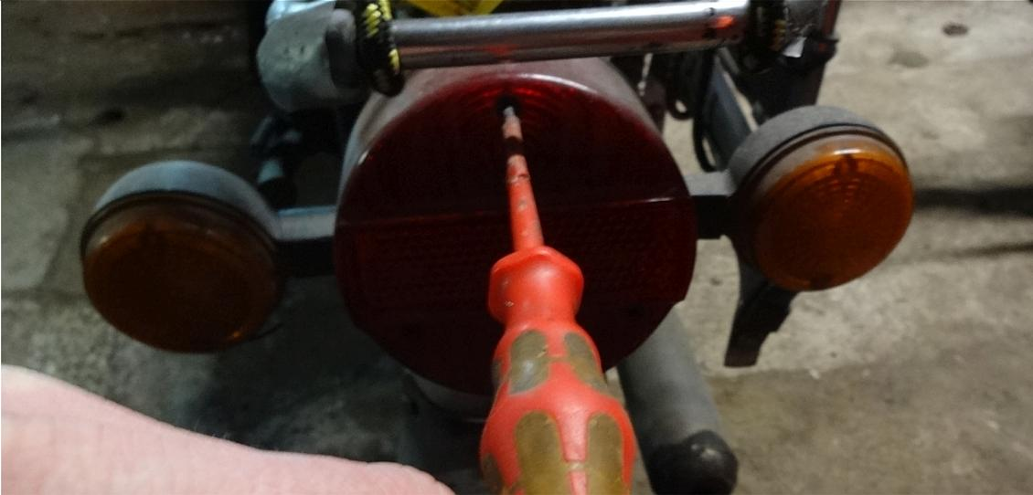
Öffnen des Rücklichtes zum Umbau der Stopplicht- und ggf. auch Rücklichtlampe
