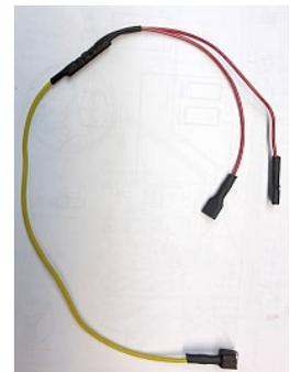
Kabel für Umbau der Blink-Kontrolllampe
