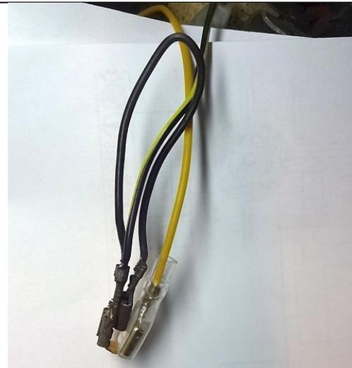
Klemme 15/51 oder 58 an Reglerausgang Hupe (gelb) stecken und die metallischen Kontakte isolieren
