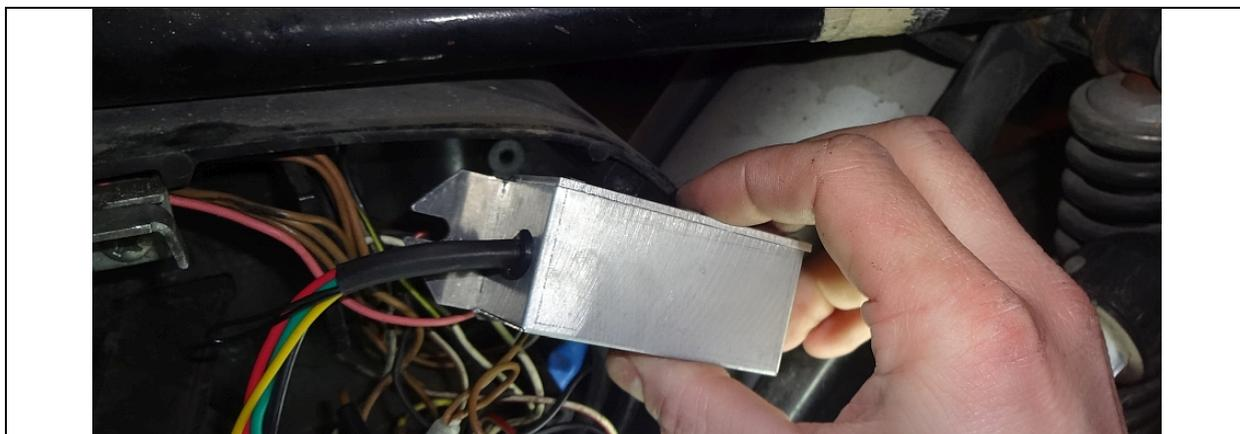
Regler in Position bringen und den Halter unter die erste Schraube am Haltesteg führen.
