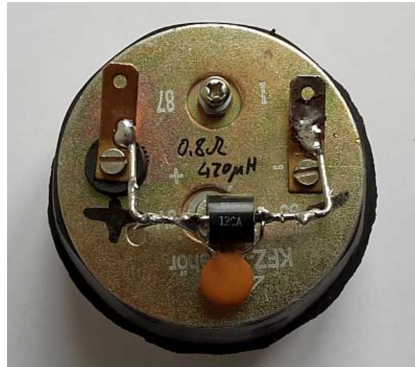
Abbildung 5 Rückansicht der Hupe mit Schutzbeschaltung
