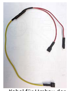
Kabel für Umbau der Blink-Kontrolllampe
